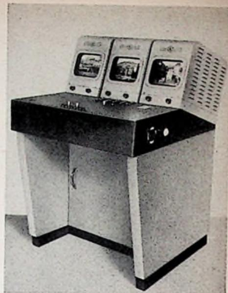
Bild 6. Mischpult zur Auswahl bzw. Mischung und Überblendung der von verschiedenen Aufnahmege-räten angelegerten Fernseh-Bildsignale
