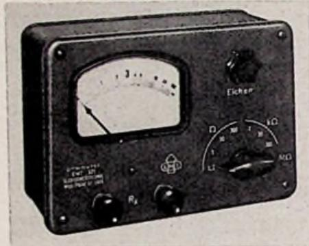
Bild 4. Ansicht des Ohmmeters EMT 321
