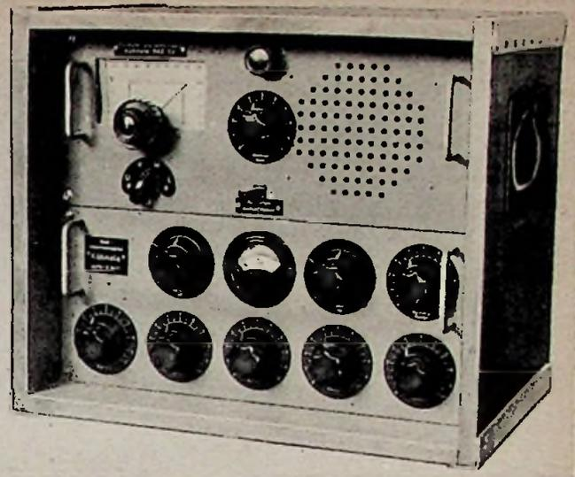
Bild 1. Mischpultverstärker (unten) und Rundfunkzusatz (oben)
